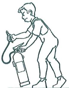
Asir la boquilla de la manguera del extintor y comprobar, en caso que exista, que la válvula o disco de seguridad (V) está en posición sin riesgo para el usuario. Sacar el pasador de seguridad tirando de su anilla.
