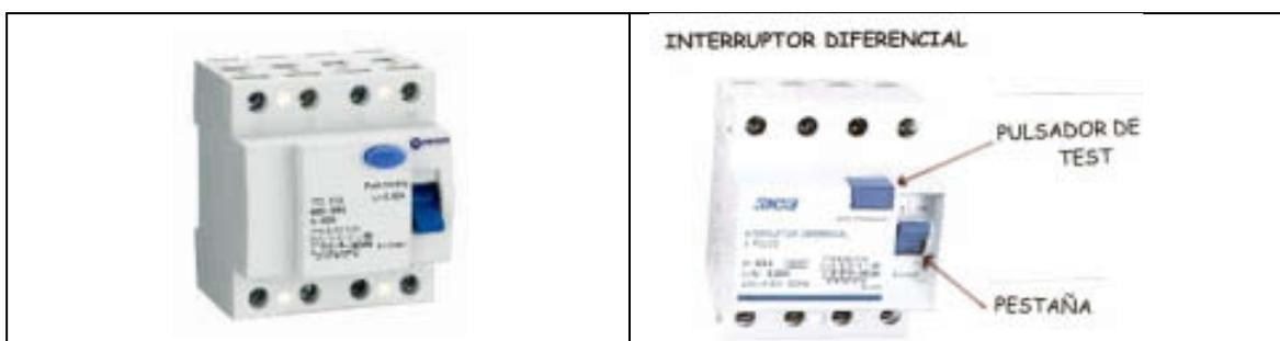
Aparte de este dispositivo, en los cuadros eléctricos hay otras protecciones como magnetotérmicos (protegen contra sobrecargas de la instalación y contra cortocircuitos) así como otros elementos. Es muy fácil distinguirlos de los interruptores diferenciales, pues no poseen pulsador de test.
